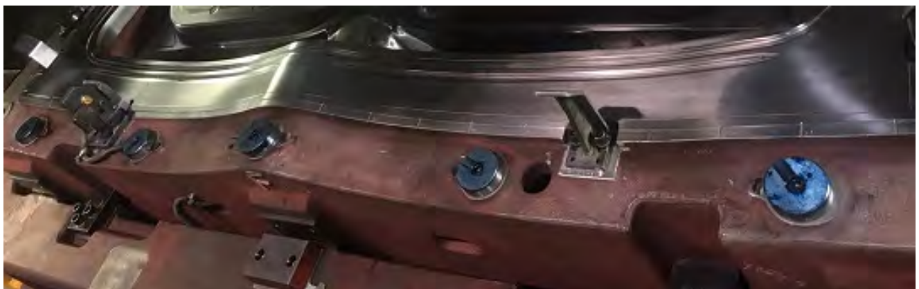
图 8 带材料状态平衡块与凹模为虚着色接触
