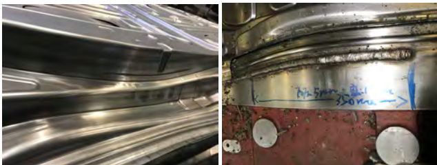
图5 零件起皱位置，拉伸筋高度加高图
