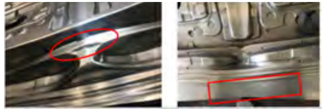
图6 零件开裂位置，拉伸筋高度降低
