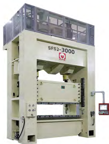
200-800 吨闭式双点 中心传动伺服压力机
