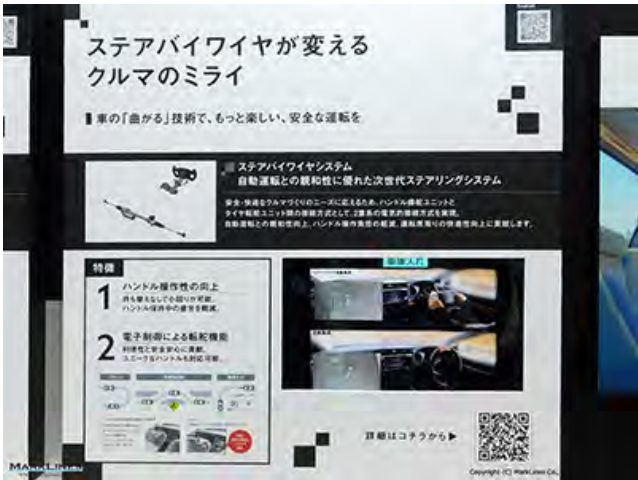
展板：线控转向系统改变汽车的未来 < 特点 > 提升方向盘操控性 · 无需换手即可实现灵活转向 · 缓解紧握方向盘时的疲劳感 · 有助于提高便利性和安全性 · 支持异形方向盘
