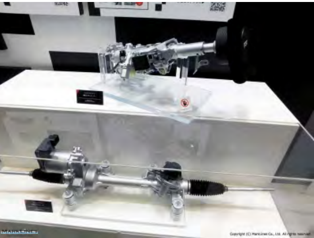
展品：线控转向系统 上排：方向盘转向装置 下排：轮胎转向装置 装置之间采用双系统电气连接
