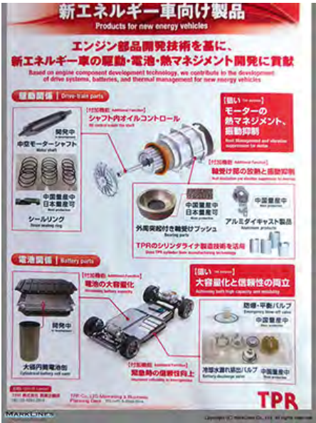
展板：新能源汽车产品 < 驱动电机相关 > • 带外圈凸起的轴承套 • 铸铝件 • 密封圈 • 空心电机轴（开发中） < 电池相关 > • 防爆和平衡阀 • 冷却水泄漏装置 放料阀 • 大直径圆柱电池罐（开发中）
