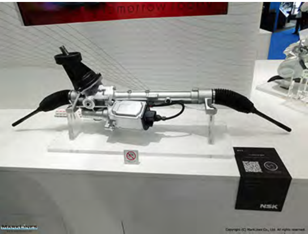
展品：单小齿轮式 EPS < 结构 > · 可变 R&P 齿轮 · 斜齿蜗轮蜗杆 · 集成电机控制单元 · 扭矩转角传感器
