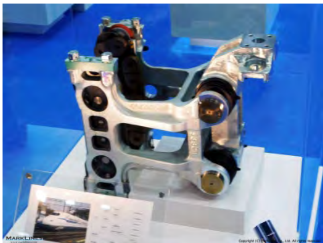
<重量>约 65kg <规格>轮边制动盘(材料:锻钢)转向架安装型 液压浮动式卡钳 带自动间隙调节机构<刹车片>材料:烧结铜合金<卡钳>材料:铸钢
