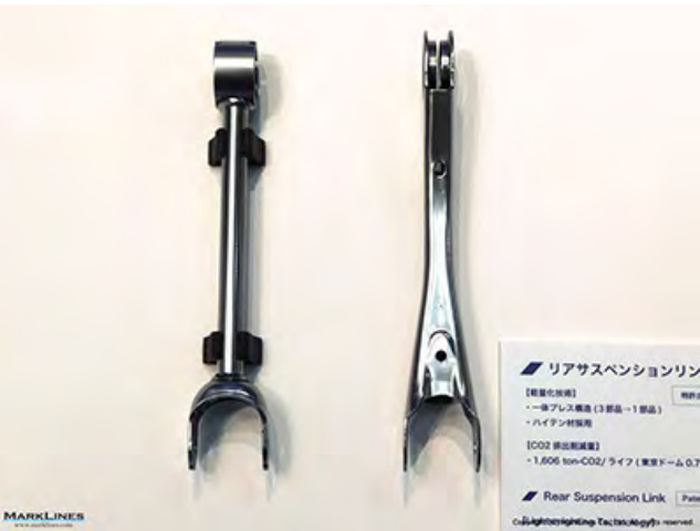
展品：后悬架连杆 • 一体式冲压结构（零部件 3 个→1 个） • 使用高强度材料
