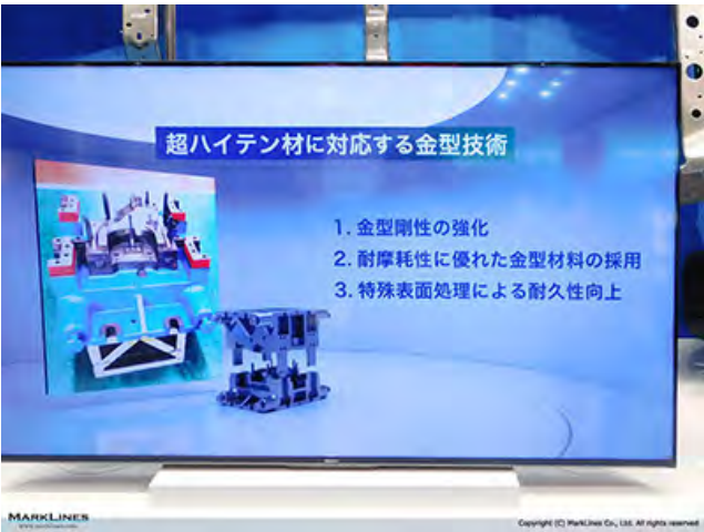
展板：用于超高强度材料的模具技术 1. 增强模具刚性 2. 采用耐磨模具材料 3. 特殊表面处理提高耐用性
