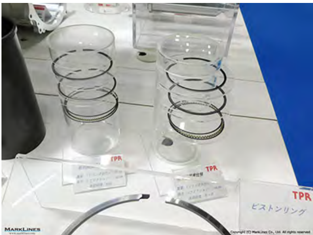
展品：活塞环的现在和过去 左 右 最新开发规格 / 40 年前量产规格 重量 21.1g / 24.3g 拉力 40N / 58.9N 表面处理 PVD / 镀层
