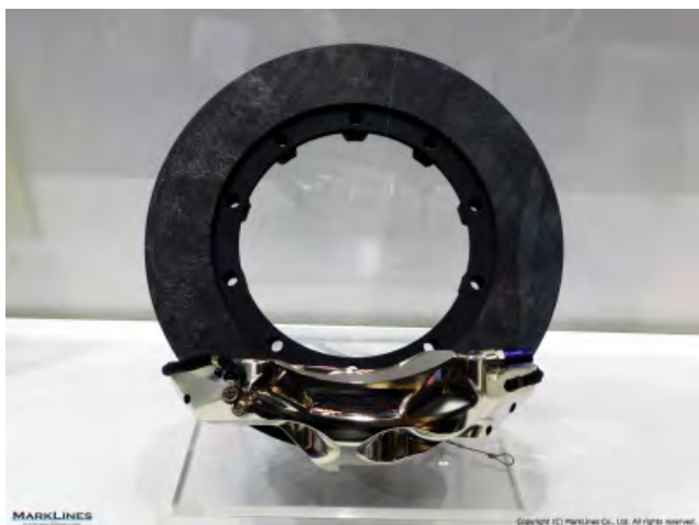
展品：用于 F1 的对向式六活塞盘式制动钳 凭借在比赛的任何情况下持续、稳定的制动力 和踏板行程赢得了迈凯伦赛车手的信任。
