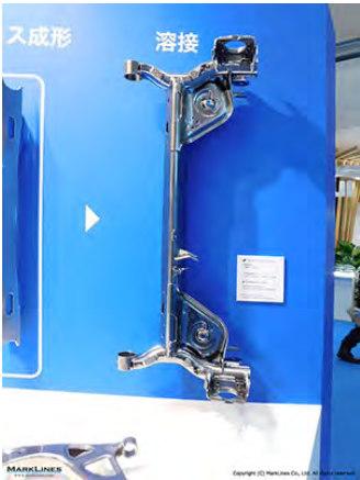
展品：减厚成型后梁 减薄成型后，中心部位厚度减少，重量减轻
