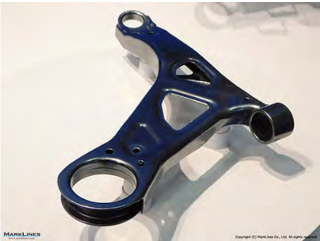
展品：前下摆臂 • 采用 980MPa 级高强度材料 • 优化结构
