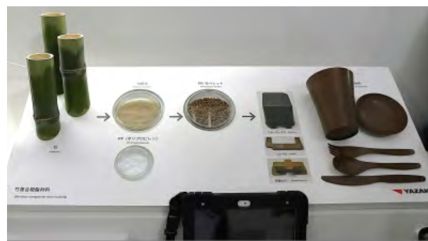
利用竹子复合树脂材料制造的 继电器盒、把手和保护罩
