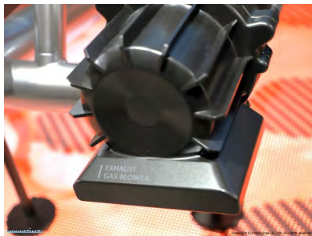
将高密度二氧化碳收集到二氧化碳罐中的 废气排风机 (Exhaust Gas Blower)
