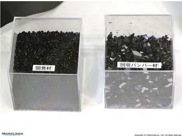
开发的材料（左）和回收的保险杠材料（右）
