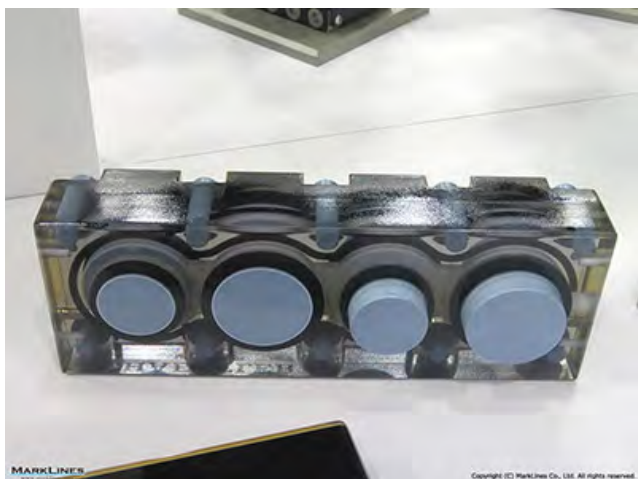
用于 S3AM 主动式 ASSB 模块的舍弗勒嵌套式液压活塞系统
