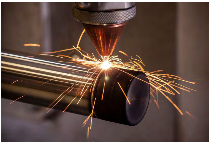
在这里您可以看到 EHLA 工艺的工作原理。通过激光辐射，可以快速、精确、高效地涂覆耐磨防腐涂层。激光熔覆的另一个优势是，它还可以用于修复，从而显著提高资源效率。
