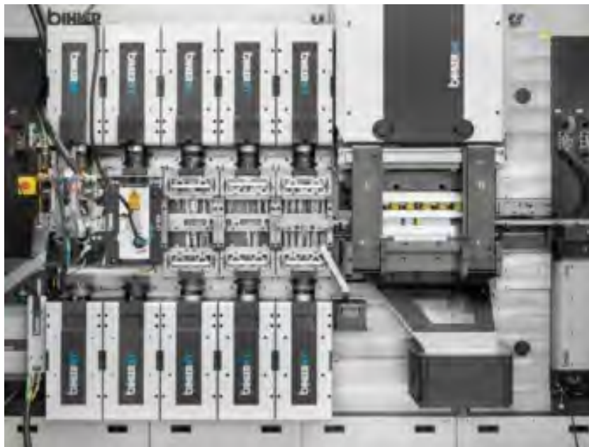
LM 2000-KT 集成成形、激光焊接和装配模块, 可实现双部件连接器的高动态生产, 是该公司在 Blechexpo 展会上的旗舰机型。
