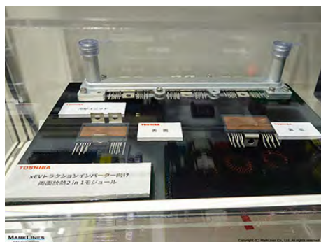
用于新能源车牵引逆变器的双面散热 2 合 1 模块 Si IGBT 展板
