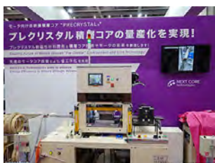
非晶材料的电机铁芯冲压演示 非晶材料冲切后的铁芯 电机铁芯材料特性对比展板
