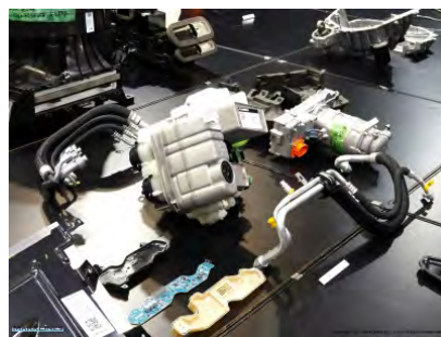
热管理系统（热管理单元和电动压缩机） 热管理单元（八通阀和超级歧管 V2） 超级歧管 V2（气液分离器、液冷式冷凝器、电磁阀）
