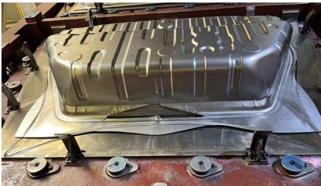
图 4 零件拉伤 & 开裂
