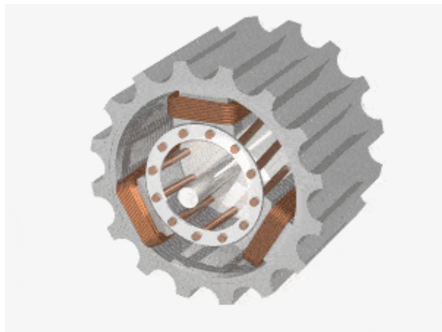
鼠笼型异步电动机示意图
