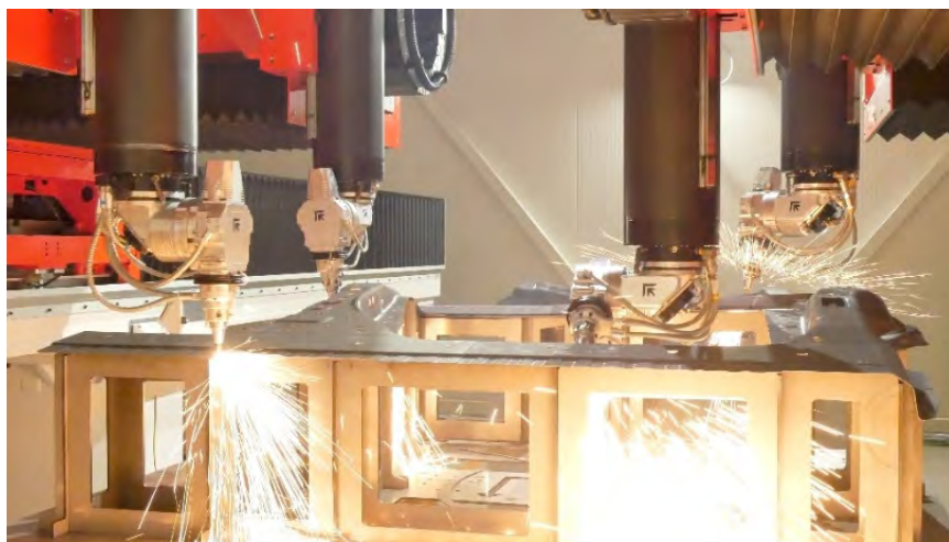
Giga Laser Next 的核心是四个激光头协同作业，同时对同一工件进行加工的独特配置
