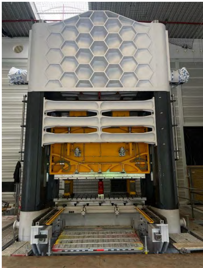
凯撒 TOP-LINE KSH2 压力机压力机内部设计的仿生结构细节
