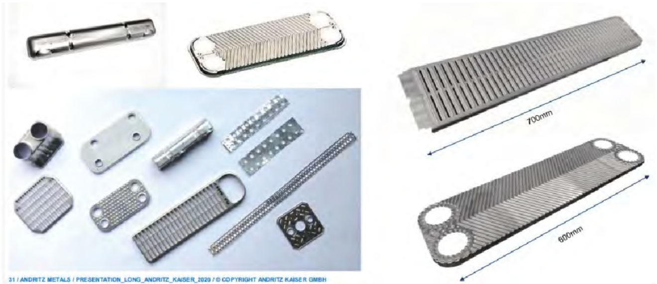
由安德里茨凯撒设备成形的金属双极板样品
