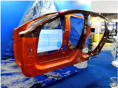
展品：双门环 材料：几种高强度钢 所用材料是以下五种类型的组合，优化了设计。 1000MPa 级 1.2mm、1.4mm；1500MPa 级 1.2mm、1.6mm；2000MPa 级 1.6mm 工艺：拼焊板→激光焊接→加热炉→热冲压→激光落料
