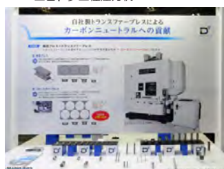
展板：自制多工位压力机 比渐进式压力机具有更好的材料良率
