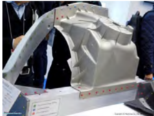
试制品：悬架塔 接合技术： 绿色：铝电阻点焊 蓝色：自冲铆接 红色：热熔自攻丝
