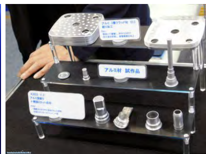
展品：各种铝制零部件 上排：3 层铝复合材料，t0.5 拉伸工艺 下排：A3003，t1.2 铝深拉伸 + 侧面 D 切割成型
