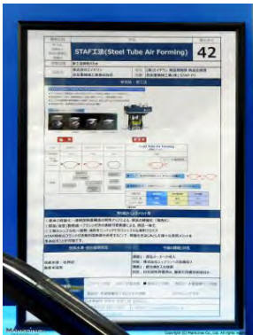
展板：STAF 工艺（Steel Tube Air Forming） 住友重机械工业的新工艺设备，特点是对钢管进行通电加热，并在吹入高压空气的同时进行压制成型，因此，可以灵活地成型具有封闭截面形状的部件。同时，模具急冷淬火，确保高强度。
