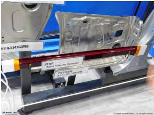
展品：车门内饰板 材料：再生铝，6000 系列 工艺：热冲压 热压成型与固溶处理同时进行
