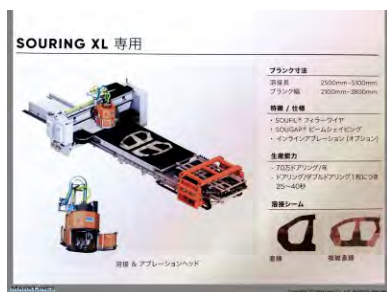
资料：拼焊高速激光焊接线 瑞士 ANDRITZ Soutec 制造 工序：拼焊 + 激光焊接
