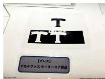
展品：非晶叠片铁芯 材料：非晶合金 工艺：冲压→叠片 专利加工技术实现非晶叠片铁芯
