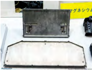
展品：显示屏镁外壳 材料：镁 AZ91D 比重 1.8（铝 2.7） 工艺：触变成型（金属注塑成型）
