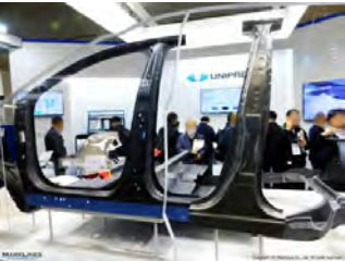
试制品：车身骨架集成部件 门环 材料：高强度钢 工艺：热冲压成型
