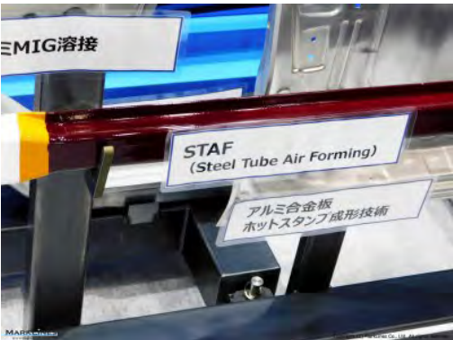
展品：横梁 材料：钢管 工艺：STAF 工艺（气压热成型） 工艺：电加热→高压空气→热压→模具急冷（淬火）
