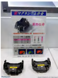
展板：高导热镁 右：新型镁合金 106g 左：铝 ADC12 160g 比重 热导率 点火温度 (W/m·K) (°C) 新型镁合金 ○ 1.8 ○ 120 1050 镁 (AZ91D) ○ 1.8 △ 53.6 600 铝 (ADC12) ○ 2.7 ○ 96
