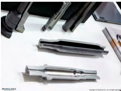
量产：电动汽车空心电机轴 材料：合金钢 SCr420 工艺：热锻径向锻造
