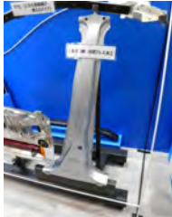
展品：中柱 材料：高强度钢板 工艺：冷压加工
