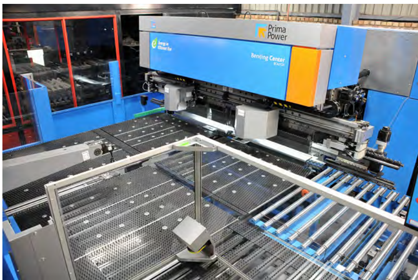
说明：由 Talmac Machine Tools 于 2024 年 3 月提供并安装，其最大折弯长度为 2750mm，最大板材长度为 2850mm，最大板材宽度为 1500mm，最大面板对角线为 3000mm，最大折弯高度为 264mm，折弯力为 41 吨，夹持力为 90 吨。
