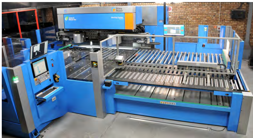
说明：普玛宝 Bce 2720 折弯中心采用伺服电动技术，配备八个独立电机和多个 CNC 轴。该款折弯中心能够处理厚度从 0.5mm 到 3.2mm 的普通钢、2.2mm 的不锈钢和 4mm 的铝材。
