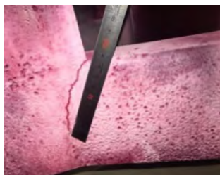
图 7 拐角直角 / 筋条高度不足
