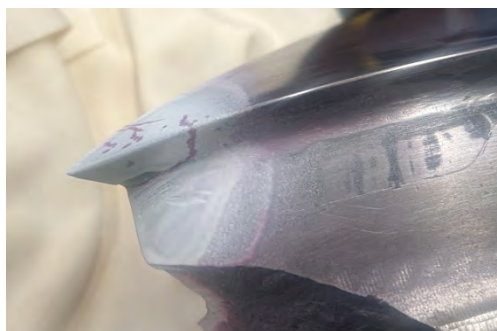
图 20 尾灯尖角裂纹
