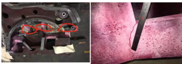
图 6 压料板过桥筋处裂纹
