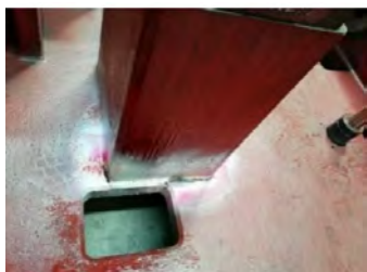
图 9 斜楔插刀底座 2 处裂纹
