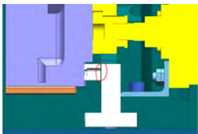
图 14 限位块为聚氨酯，间隙 2mm
