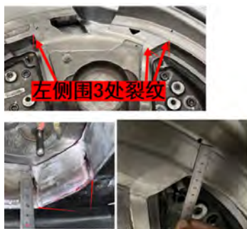
图 15 侧围压料 3 处裂纹
