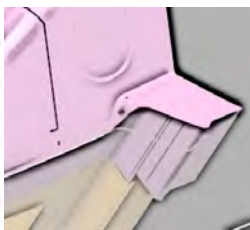
图 5 增加筋条支撑
