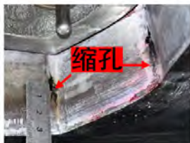
图 16 压料板铸件缩孔
