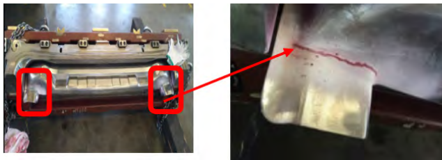
图 3 斜楔整形刀块裂纹，左右对称产生
