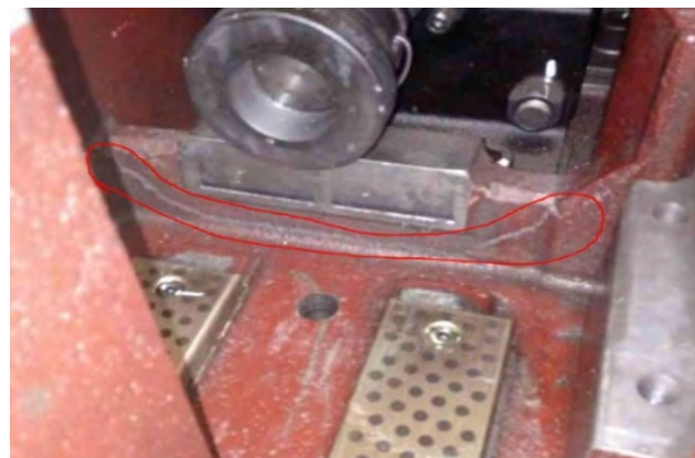
图 12 滑车刚性限位面断裂
