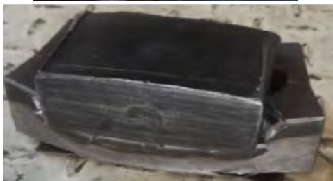
图 28 上模 2 处导向腿开裂
