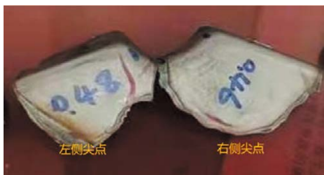
图 16 左侧尖点减薄 0.48mm，右侧尖点减薄 0.46mm
