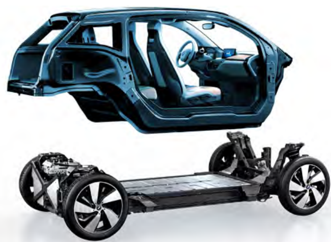
图 2 BMWi3 座舱 (Cabin) 使用 CFRP 复合材料实例
