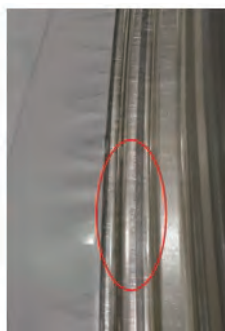
图 2 某零件拉伸筋上脱锌
