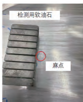
图 1 某零件的麻点及检测工具
