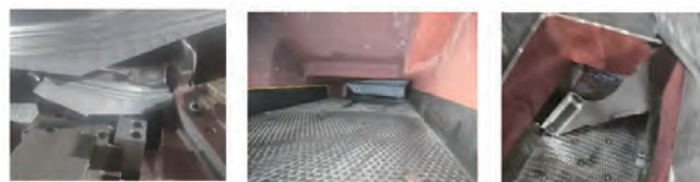
图 5 某车型模具由于落料空间不足卡废料照片
