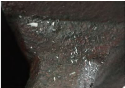
图 8 生产过程中刀口碎屑
