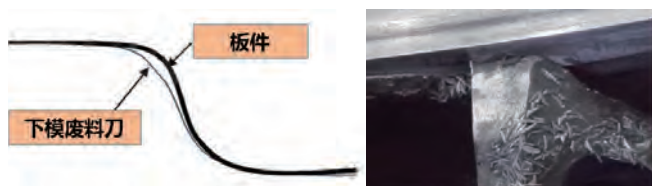
图 10 某车型下模板件不符型、切除月牙状碎屑
