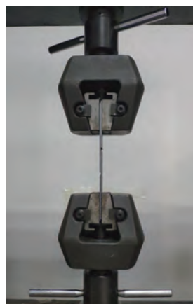
图 2 焊点抗剪切强度试验
