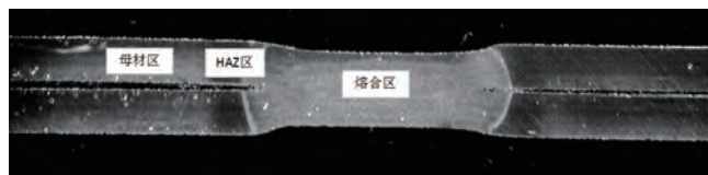
图 3 热成型高强度钢点焊接头宏观组织
