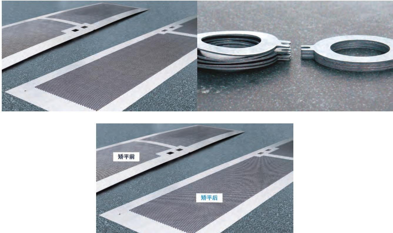
率。在冲压加工时，矫平后的钣金件可以增加冲床的行程数，从而提高生产效率。
