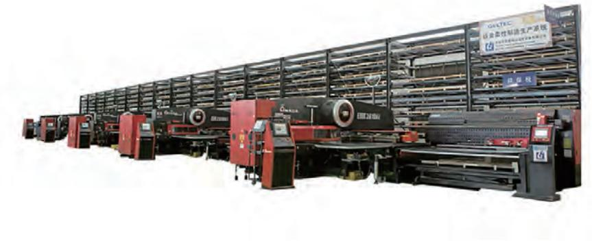
产品的加工工序, 最大限度地缩短产品加工、等待时间, 在制产品数量至少减少 60%。④质量高。零件装卸一次即可完成所有加工, 减少人员操作环节, 通过自动检测、反馈数据实现实时管理, 能及时发现问题并予以处理, 提升产品质量。⑤产品应变能力高。物料装置具有可调性, 系统平面布局合理, 便于增减设备, 满足市场需求。⑥场地使用面积少。板材仓库直接放置在车间并与设备相连, 不需设置独立的仓库, 实现了物料的智能调度。
