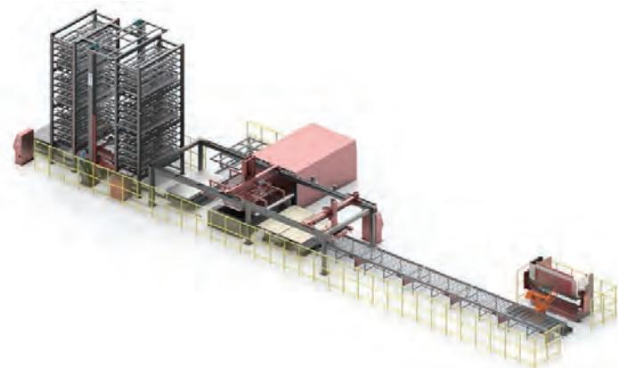
理。堆垛机在 X 方向的行走速度范围为 0 ~ 120m/min, 货叉在 Y 方向的运行速度范围为 0 ~ 30m/min, 在 Z 方向的提升速度范围为 0 ~ 75m/min。PLC 系统全线采用总线控制, 减少了设备的走线及 PLC 扩展模块的使用量, 提高了控制的时效性及稳定性, 满足了子系统为多台设备同时提供材料的需求。
