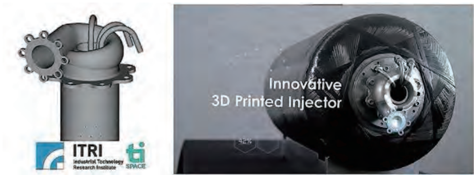
图 4 3D 打印燃料混合喷嘴几何设计 ( 左 ) ; 晋升太空研发之火箭引擎 ( 右 )
