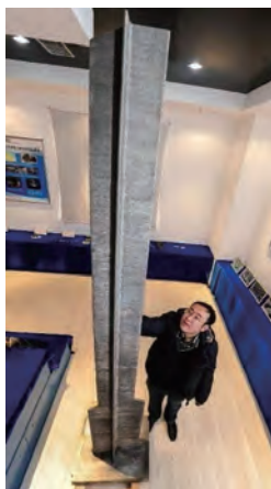
图7 铂力特公司展示采用具有自主知识产权的“3D 打印制造”技术，图中为客机 C919 的中央翼缘条
