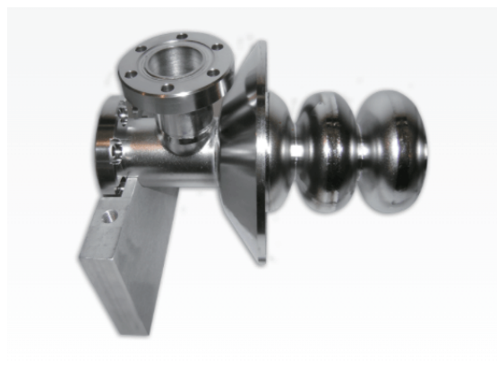
图2 指向性能量沉积成品，在零件上延伸三维结构
