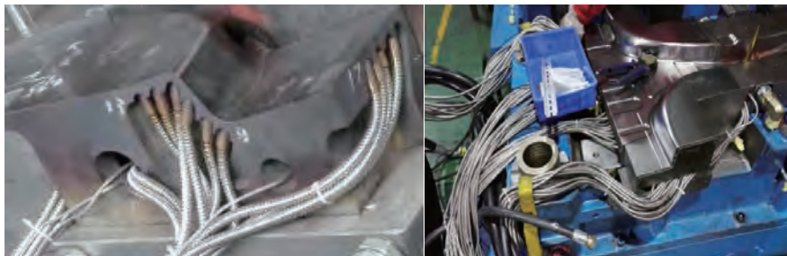
图 2 软区部位模具内部示意图
