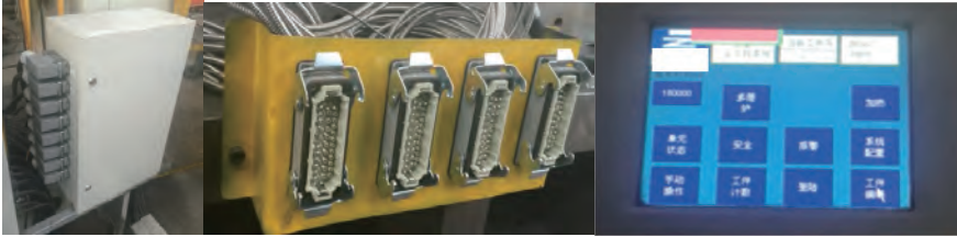
图 3 软区部位模内加热外部加热设备
