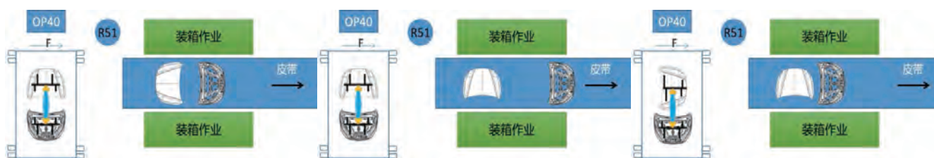
图4 不同方案不同投料方式零件与皮带位置示意图
