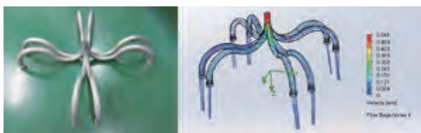
图7 积层制造歧管仿真分析与制造
