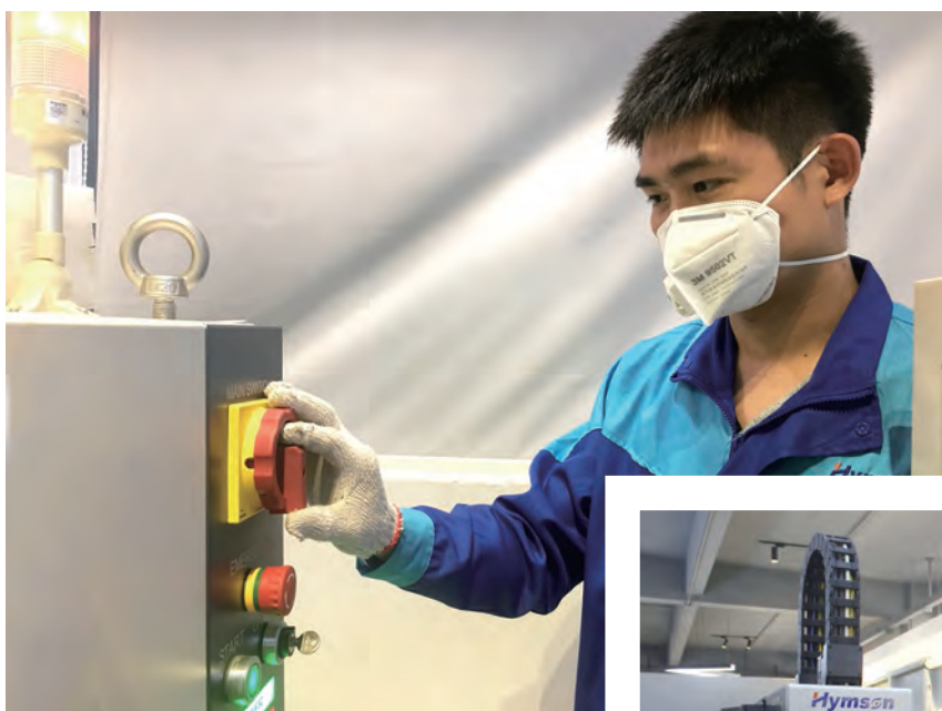
图 5 启动激光器，指示灯显示绿灯
