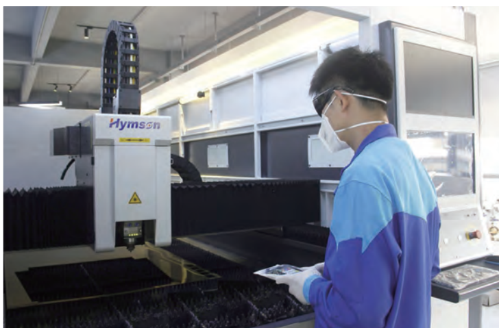
图 6 检查 X/Y/Z 轴正常情况
